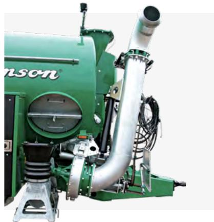
**SAP 1\*** Eingliedriger, seitlich montierter Füllarm mit integrierter Pumpe. Einfaches und schnelles Befüllen des Güllewagens über einen niedrig angebrachten Trichter.
