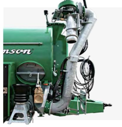
**SAP 2\*** Zweigliedriger, seitlich montierter Füllarm mit integrierter Pumpe. Universalfüllarm, der über niedrige oder hohe Fülltrichter mit Stützen und von schwer zugänglichen Güllelagern aus befüllt werden kann.
