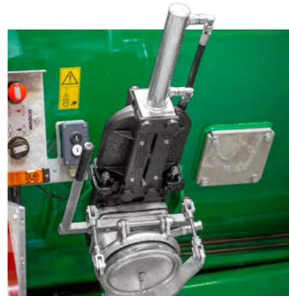
**Füllstützen mit hydraulischem Spatenschieber\*** Der integrierte Füllstützen sorgt für ein schnelles Befüllen direkt über den SAMSON Ejektor\*. Das System ist mit Schlauchschnellkupplungen und einem von außen zu bedienenden, hydraulischen Spatenschieber\* versehen.
