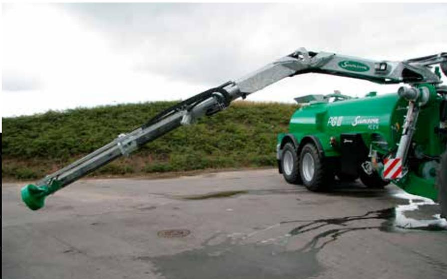
Der Pumpenturm ist kompakter. Der 6" große Rücklauf ist in den Pumpenturm integriert. Der doppelte Teleskopauserschub stellt eine lange Reichweite sicher.
