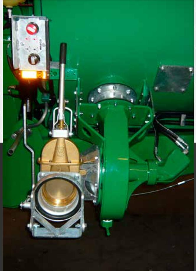
Füllpumpe mit Schlauch
