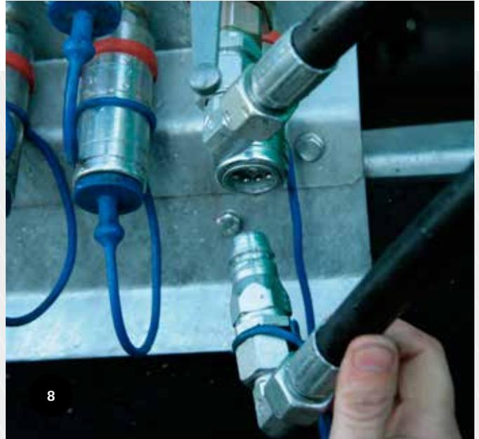
Die neuen "Push - Pull"-Schnellkupplungen erlauben verbesserte Kuppungsfunktionen zwischen Wagen und Gerät.
