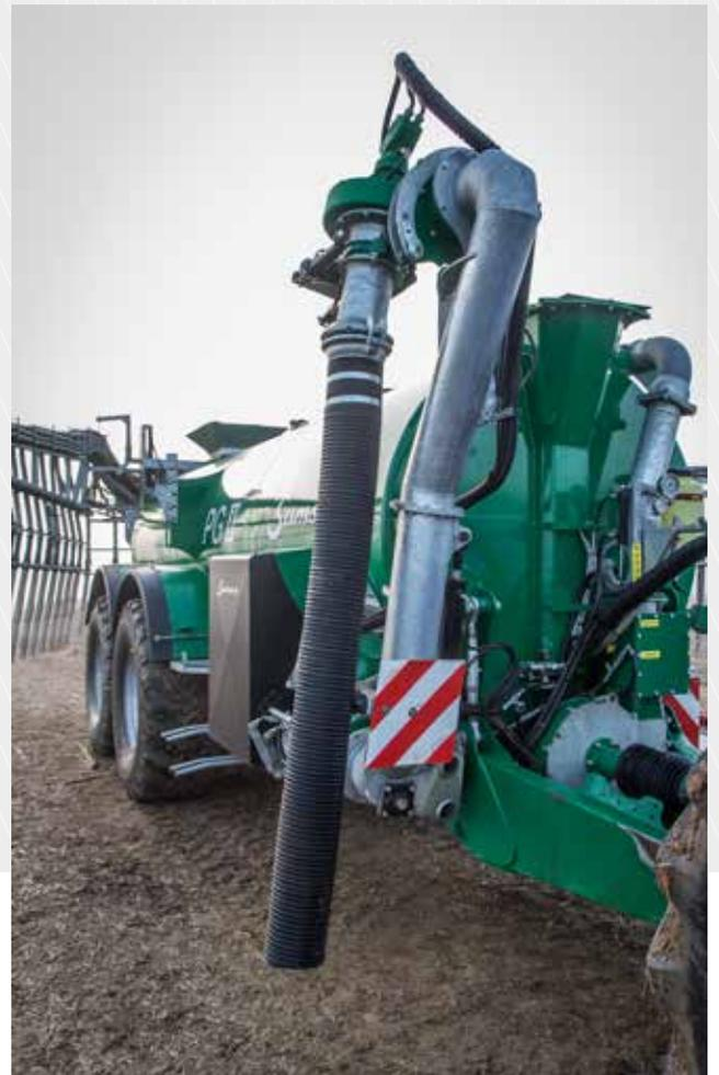
SAP2 mit Füllschlauch montiert
