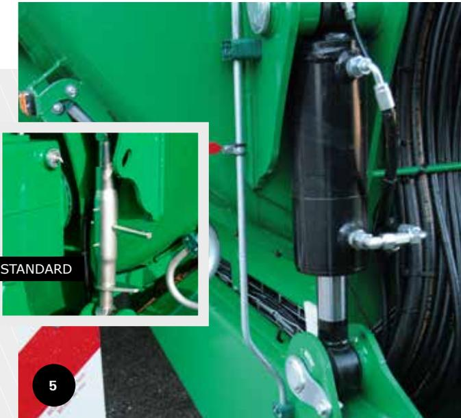
Die gefederte Zugdeichsel sichert optimalen Komfort beim Fahren. Außerdem kann die Koppelhöhe verstellbar werden.
