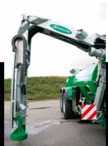
Der Pumpenturm ist flexibler und lässt sich leichter in Öffnungen von abgedeckten Güllebehältern oder in Güllelagern unter dem Stall bewegen.
