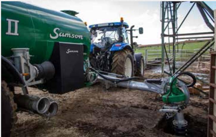
Direktbefüllung der unterirdischen Lagerung von Gülle
