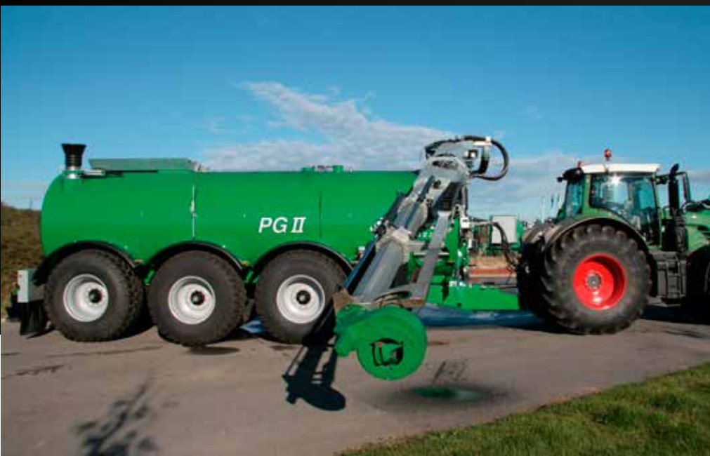
Pumpenturm mit Teleskop
