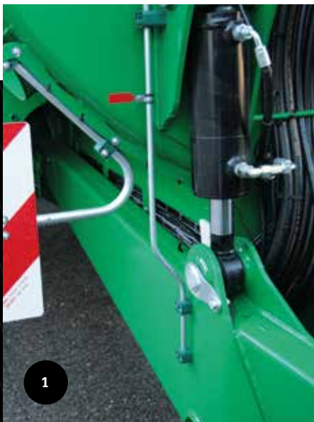
Die gefederte Zugdeichsel sichert optimalen Komfort beim Fahren. Außerdem kann die Koppelhöhe verstellt werden.
