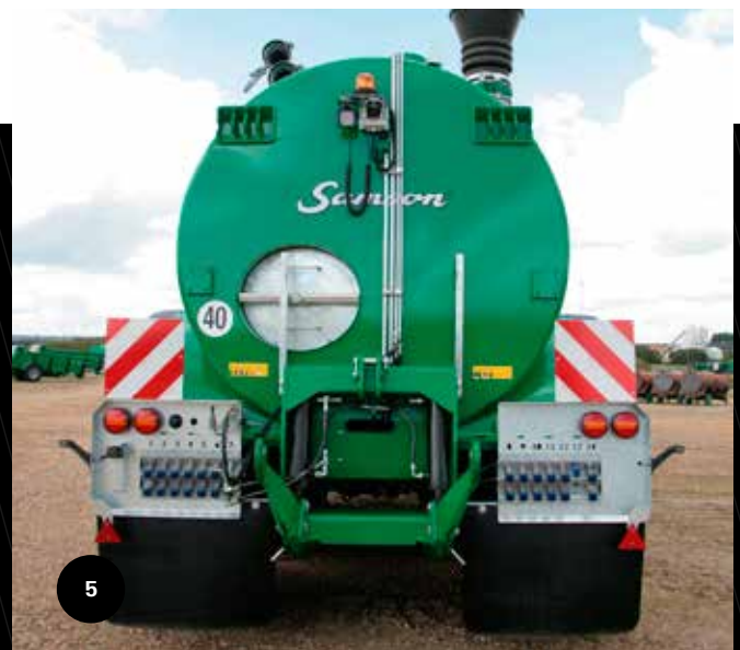
Die neuen "Push and Pull"-Schnellkupplungen erlauben verbesserte Kopplungsfunktionen zwischen Wagen und Gerät.
