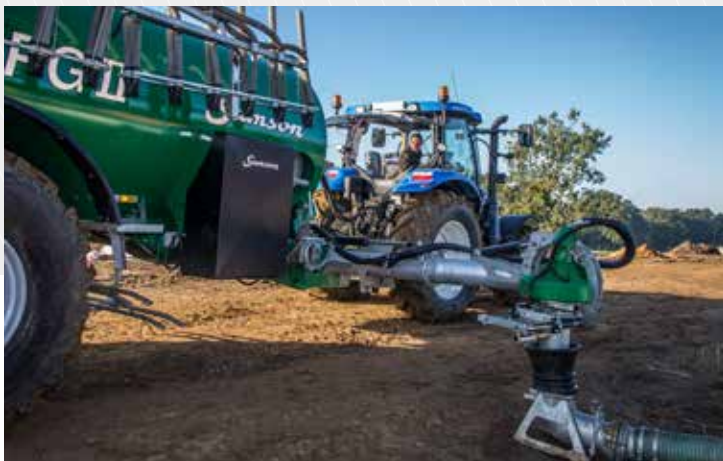
Befüllung durch Andockstation.
