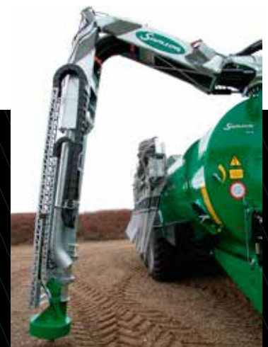
Der Pumpenturm ist flexibler und lässt sich leichter in Öffnungen von abgedeckten Gülletanks oder in Güllelagern unter dem Stall fahren.
