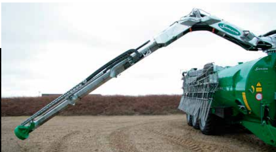
Der Pumpenturm ist kompakter. Der 6" große Rücklauf ist in den Pumpenturm integriert. Der doppelte Teleskopauserschub stellt eine lange Reichweite sicher.
