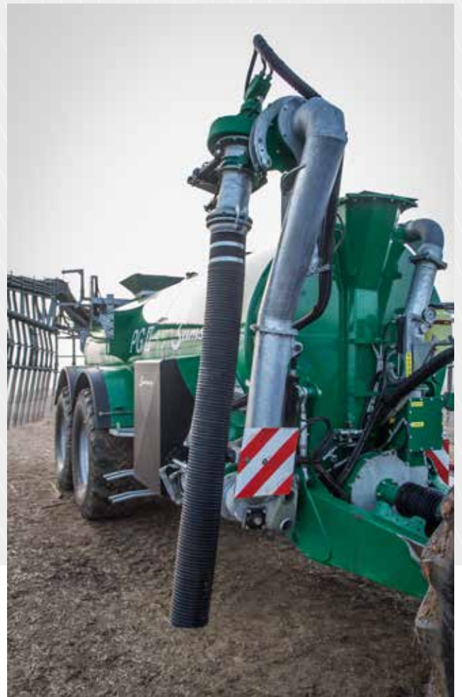
SAP2 mit Füllschlauch montiert
