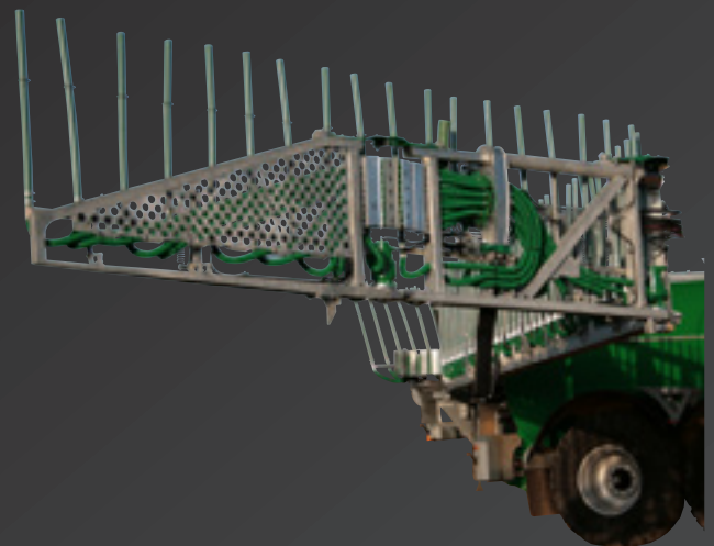
Das neue Schleppschlauchgestänge SHB4-36m enthält weniger Schlauchmeter.
