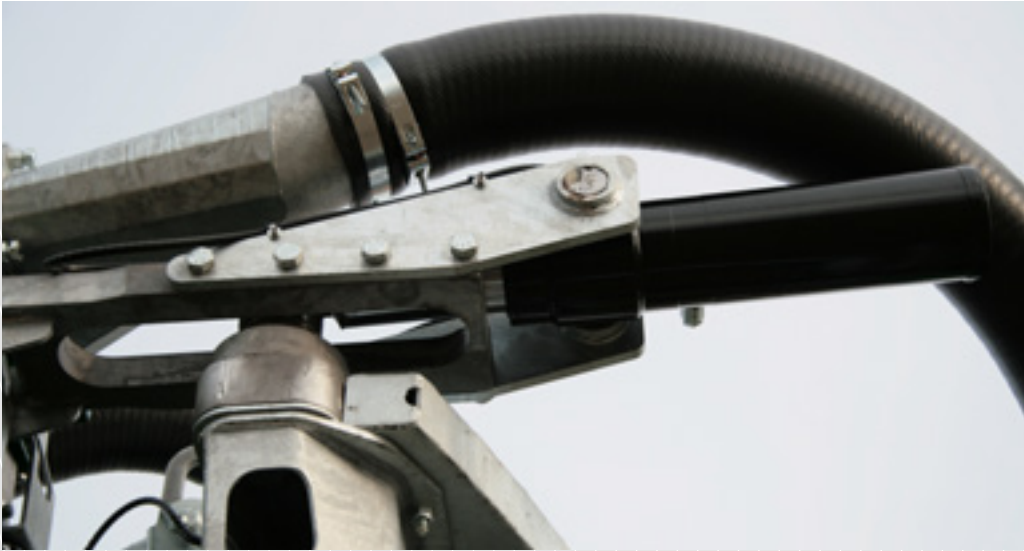
Die beiden großen Seitenarme sind unten mithilfe von Scharnieren befestigt und werden oben von einem großen Zylinder gehalten.
