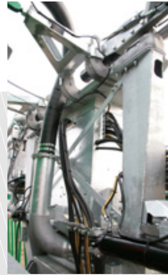
Das Gestänge hat einen einfachen Mittelrahmen ohne bewegliche Teile.
