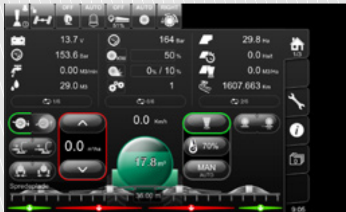
Das Gestänge wird mithilfe eines eigenen Jobrechners und einer eigenen Hydraulikanlage, die am Gestänge befestigt ist, gesteuert und reguliert.
