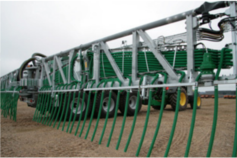
Das neue Anti-Tropf-System dreht die Schläuche, sodass die Schlauchenden nach oben zeigen.
