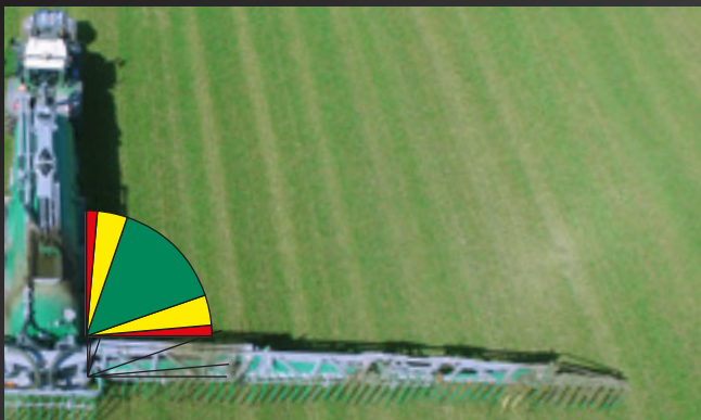
Die Höhe des Gestänges soll von drei Ultraschallsensoren überwacht und reguliert werden.
