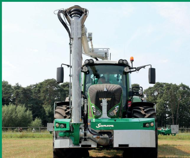
Der seitlich montierte Füllarm sorgt für optimale Sicht aus der Kabine.
