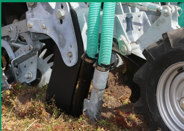
Speziell entwickelte Düsen mit integrierten Gülleschläuchen platzieren die Gülle genau hinter dem Zinken. Die Düsen lassen sich leicht einstellen und die Platzierung der Güllestreifen dadurch anpassen.
