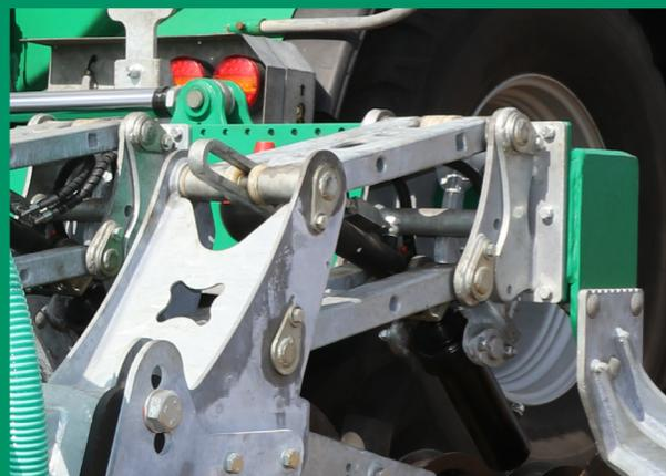
Die Parallelogrammaufhängung gewährleistet eine präzise, reihenindividuelle Steuerung der Tiefe. Dadurch wird die Gülle stets in der voreingestellten Tiefe abgelegt.
